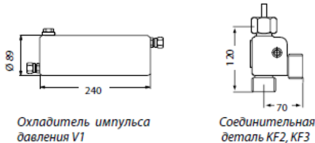
Рис. 6. Габаритные размеры охладителя импульса и соединительной детали
