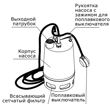
Рис. 1 Конструкция насосов APV 0,37-1,1 кВт
